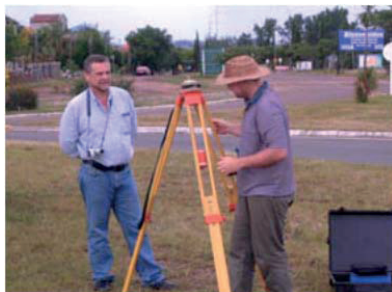
Fig 91. Localización Topográfica de la perforación.
